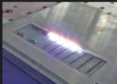
※50Wのファイバーレーザーでアルミ板を彫刻
