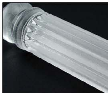
円柱の亚克力材料を立体的に彫刻 (ロータリーフィクスチャを使用)
